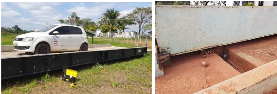
Figura 67. Balança Rodoviária da Área de Triagem, Transbordo e Reciclagem, remanejada para uso na UTRE, em 07 de julho de 2021
